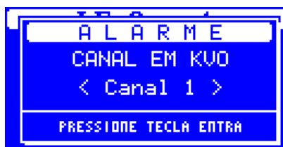
Figura 60 – Tela do alarme de KVO
