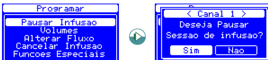
Figura 32 – Procedimento para pausar a infusão
