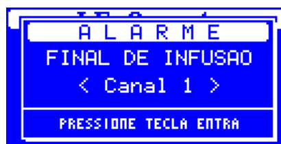
Figura 57 – Tela do alarme de fim de infusão
